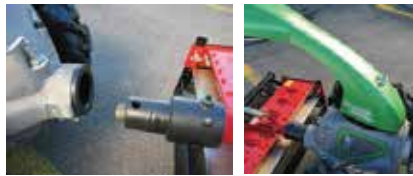
Acoplamiento rápido de implementos.
